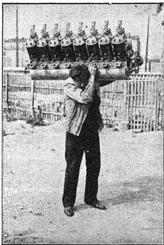
FIG. 183. — Un moteur Antoinette 100 chevaux, 16 cylindres.
